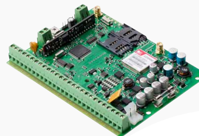
ESIM364 har fyra utgångar och åtta termostatingångar
